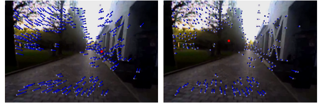
(a) 回転成分を含んだフロー (b) 並進成分のみのフロー 図3 オプティカルフローからの並進成分の分離．前フレームの画像を回転させ，特徴点座標を求めることで，回転成分と並進成分を含んだフロー (a) から，並進成分のみのフロー (b) を得ることができる．各画像において，白い四角は現在のフレームの画像における特徴点座標であり，黒い四角は，(a) では前フレームの画像における特徴点座標，(b) では前フレームを回転させた画像における特徴点座標である．赤い丸は，各フローまでのユークリッド距離の合計が最小となる点として推定されたフローの交点を示す．
