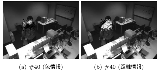
図8 色情報と距離情報の観測結果
