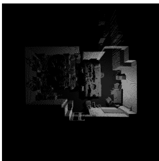
図 2 レンジセンサから得られる室内形状
