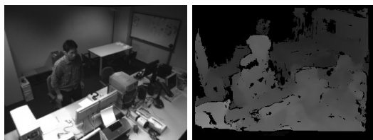
図 1 ステレオビジョンカメラから得られる色情報及び距離情報
